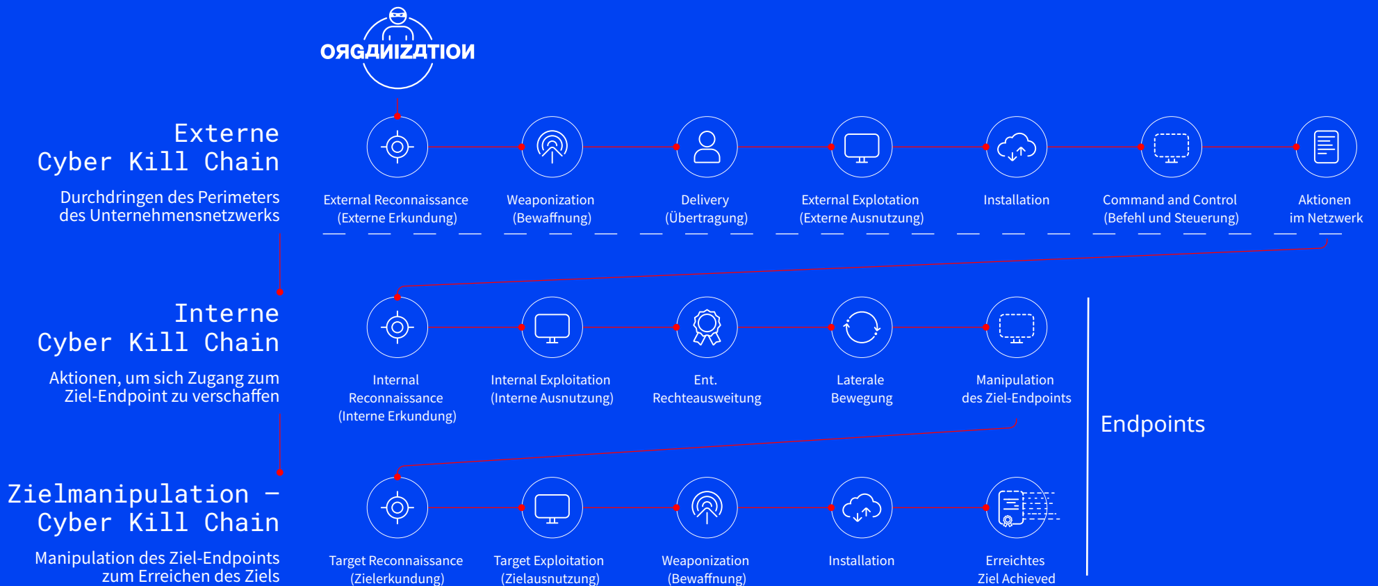
Abbildung 1: Die erweiterte Cyber Kill Chain. Aktionen des Angreifers, um sich Zugang zum Ziel-Endpoint zu verschaffen, und Endpoint-Manipulation zum Erreichen dieses Ziels.
